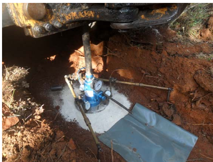
Sl. 4.1 Ispitivanje zbijenosti tla kružnom pločom
