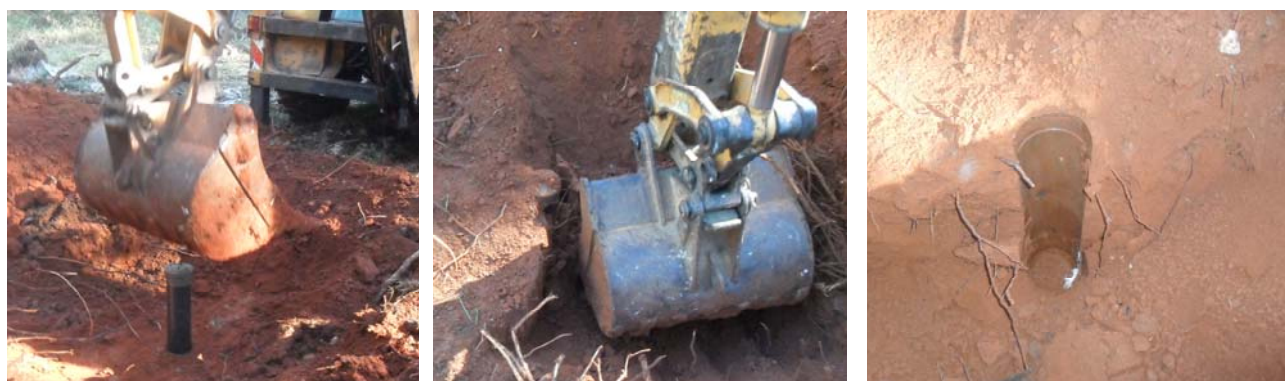
Sl. 2.1 Uzimanje neporemećenog uzorka na poziciji sondažne jame SJ-11
